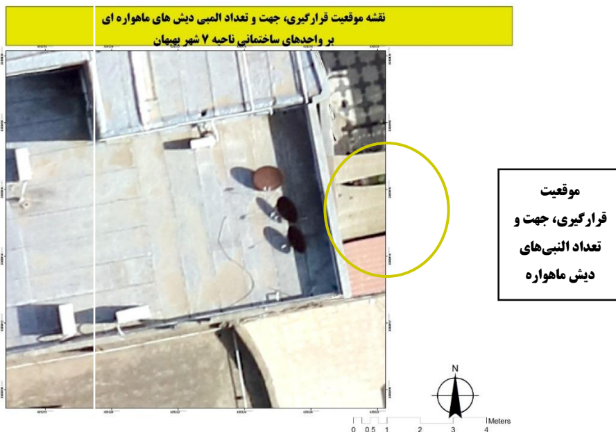
شکل (۳) نقشه موقعیت قرارگیری، جهت و تعداد LNB های دیش‌های ماهواره در واحدهای شهر بهبهان
