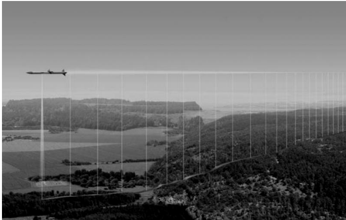
شکل ۲) ناوبری بر مبنای پستی و بلندیهای زمین
