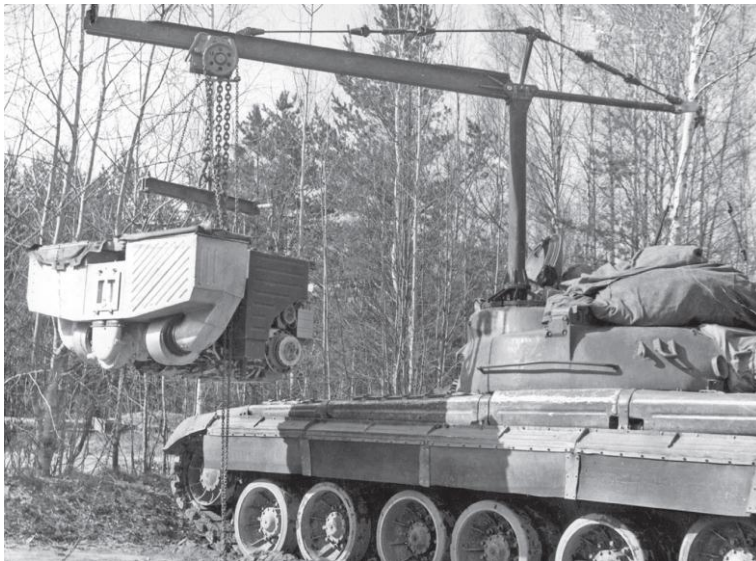
شکل (۶) نمونه‌ای از تجهیزات ابتکاری یک بالابر با مکانیزم محرک دستی جهت جداسازی پیش‌رانه تانک روسی بدون نیاز به خودروی بازیابی و جرثقیل آن.
